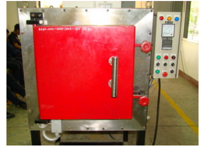
รูปที่ 4 เตาชุบโลหะที่ใช้ในการอบชุบชิ้นงาน
