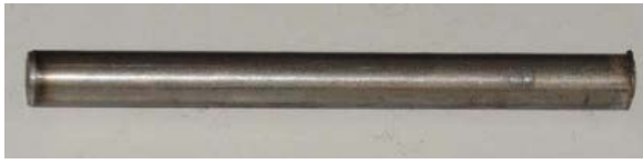
รูปที่ 3 ชิ้นงานเหล็ก AISI1045 เส้นผ่านศูนย์กลาง 10 มม.
