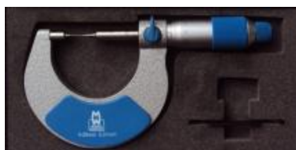
รูปที่ 5 ไมโครคาลิปเปอร์สำหรับวัดความหนาชิ้นงาน
