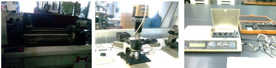
(ก) เครื่องกลึง (ข) กล้องจุลทรรศน์ยี่ห้อโมติก (ค) เครื่องวัดค่าความหยาบผิว
