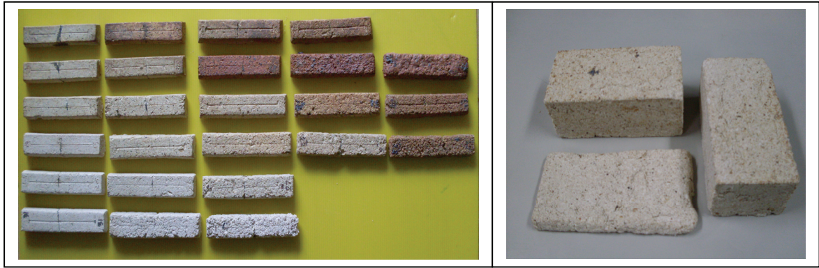
ภาพที่ 4 ซึ้นงานตัวอย่างและซึ้นงานอิฐทนไฟ
