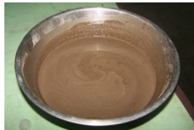
3-4 ซีโอโพลิเมอร์มอร์ต้าแก้วอัตราส่วน 1:1:1
