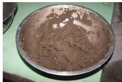
3-2 ซีโอโพลิเมอร์มอร์ต้าแก้วอัตราส่วน 1:0.25:0.25
