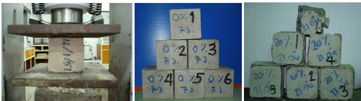
ภาพที่ 6 เครื่องทดสอบ Universal Testing Machine กับตัวอย่างขนาด 5 x 5 x 5 เซนติเมตรก่อนและหลังทดสอบ
