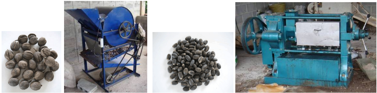
ภาพที่ 3 ผลแห้งของสนุดำ เครื่องร่อนเมล็ดสนุดำ เมล็ดสนุดำและเครื่องหีบหรือบีบอัดเมล็ดสนุดำ
