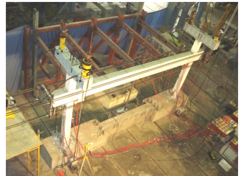
รูปที่ 5 การติดตั้งตัวอย่างทดสอบในห้องปฏิบัติการ
