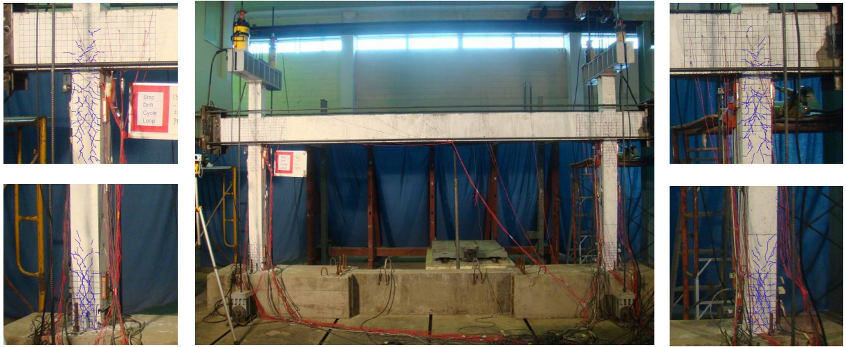
รูปที่ 8 ลักษณะการเสียรูปที่ระยะเคลื่อนตัวสัมพัทธ์ 3%
