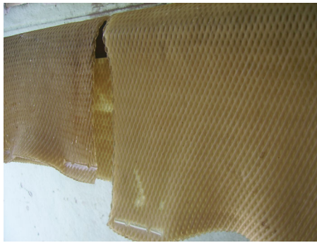
รูปที่ 10 แผ่นยางพาราหลังจากอบแห้ง (Moisture content, 10.5 % db)
