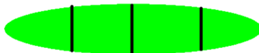
รูปที่ 4 การวัดเส้นผ่านศูนย์กลาง 3 ตำแหน่ง
