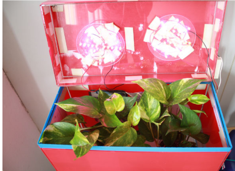
รูปที่ 3 การติดตั้งหลอดไดโอดเปล่งแสงชนิดพิเศษในภาชนะที่เพาะเลี้ยงต้นไม้
